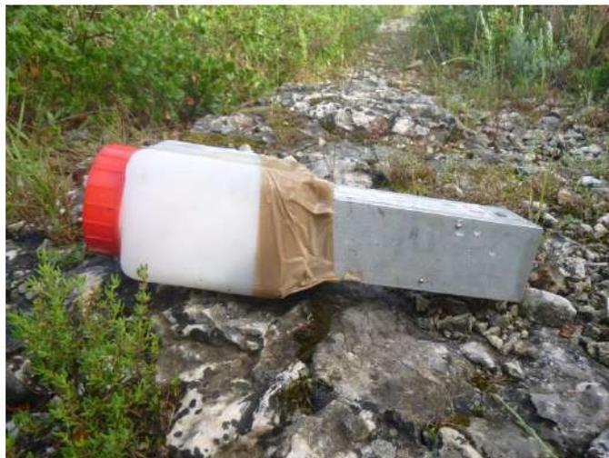
**Figure 4 : Photographie d'un piège INRA avec dortoir en plastique**
