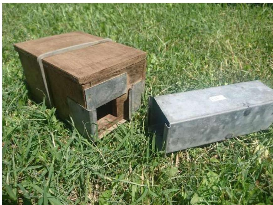
Figure 18 : Photographie d'un piège INRA et d'un dortoir en bois avec système d'attache
